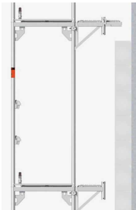
Adattamento alle geometrie dell'edificio con mensole.
